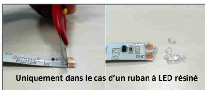
A l'aide d'un cutter, enlever soigneusement la résine se trouvant sur la zone de soudure sans blesser le circuit
